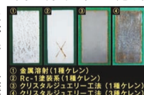
① 金属溶射(1種ケレン) ② Rc-1塗料系(1種ケレン) ③ クリスタルジュエリー工法(1種ケレン) ④ クリスタルジュエリー工法(3種ケレン)
