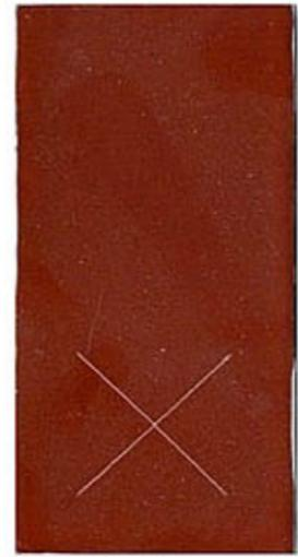
アースコート防錆-塗装システム(防錆層のみ)
